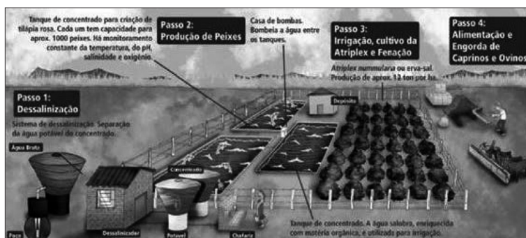
Figura 1 - Uso adequado de efluente concentrado do sistema de dessalinização
